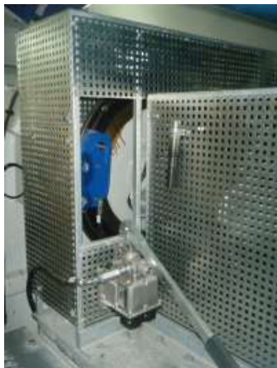
Detalle de la ventana en la protección del disco de freno para bloqueo del rotor.
